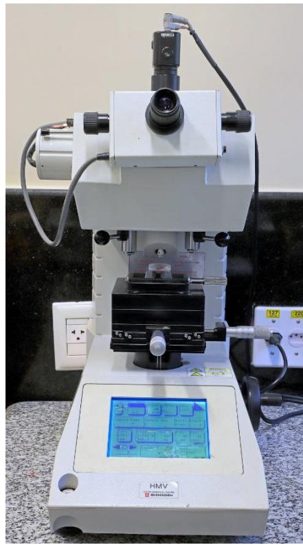
Figura 10. Microdurômetro (Shimadzu, HMV-2 Micro Hardness Tester, Shimadzu Corporation, Kyoto, Japão) do Laboratório de Dentística da FORP-USP.
