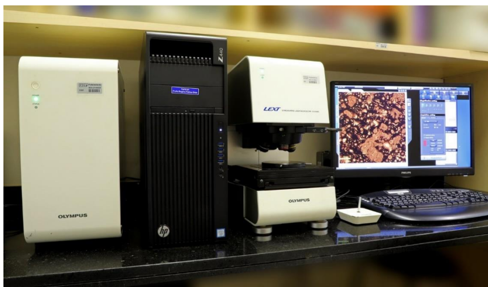
Figura 8. Microscópio Confocal a laser do Laboratório de Dentística da Faculdade de Odontologia de Ribeirão Preto FORP-USP.
