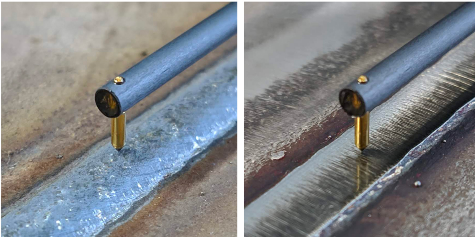
Figura 24: Detalhes do posicionamento da ponta do rugosímetro durante as medições.
