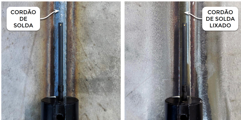
Figura 23: À esquerda, a medição de rugosidade no cordão de solda antes da realização do lixamento e à direita, a medição de rugosidade no cordão de solda após a realização do lixamento.
