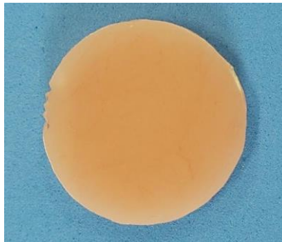
Figura 7: corpo de prova resina acrílica após polimento. Fonte: acervo de Sarah Ribeiro Cruz Araújo
