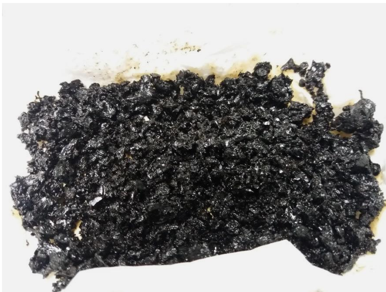
Figura 11 - Emulsão GT após tratamento térmico a 250 °C e filtragem à vácuo.
