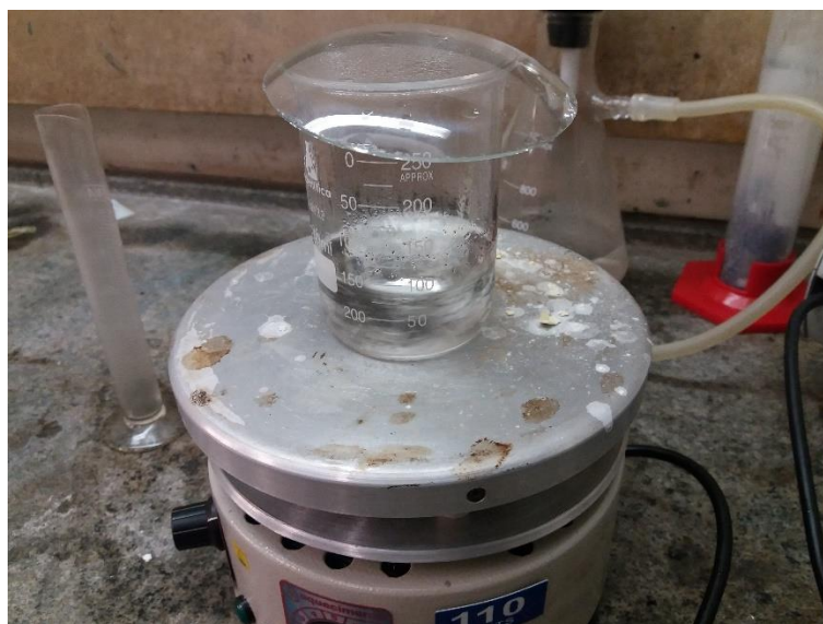
Figura 8 - Tratamento das amostras com HNO 3 a quente.
