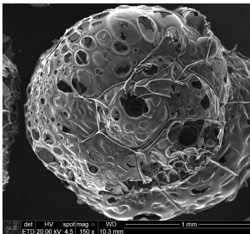
Figura 38 - Micrografia obtida por MEV da amostra ESP tratada com \text{HNO}_3 .
