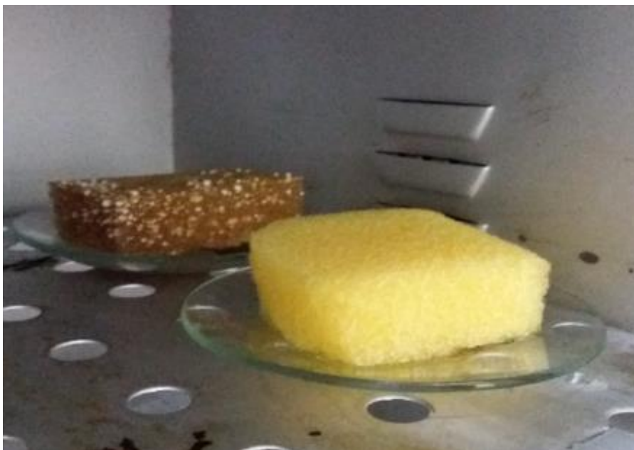
Figura 16 - Esponja impregnada com solução de sacarose (ao fundo) e controle após 1 h em estufa a 120 °C.
