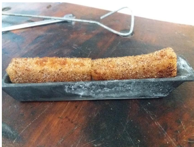
Figura 7 - Preparação para a carbonização da esponja impregnada.
