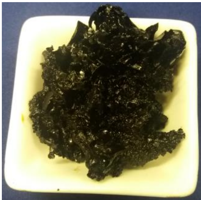
Figura 12 - Emulsão C após tratamento térmico a 250 °C e filtragem à vácuo
