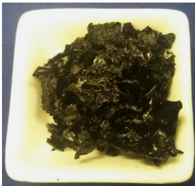
Figura 13 - Emulsão SA após tratamento térmico a 250 °C e filtragem à vácuo.
