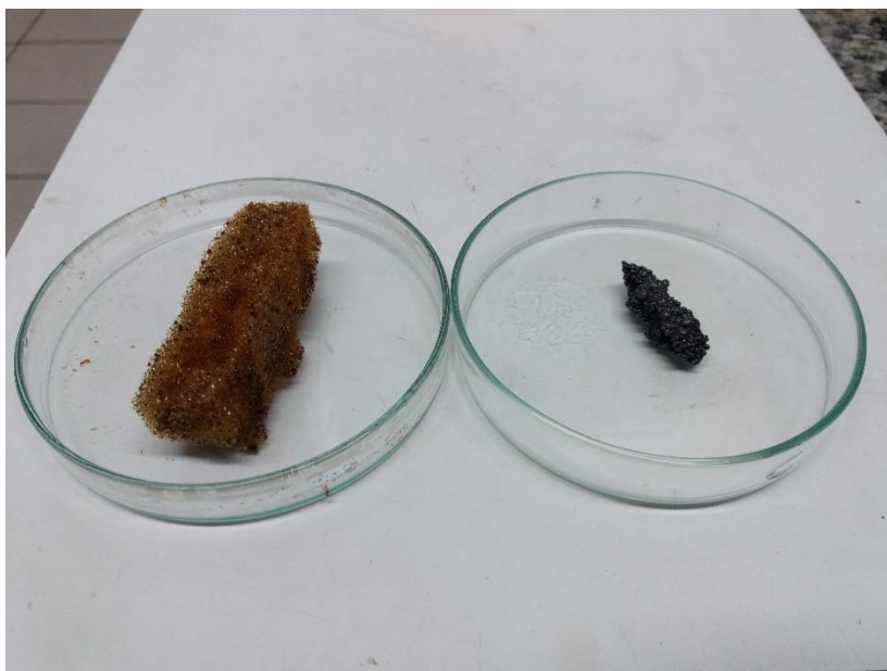
Figura 19 - Alteração morfológica ocorrida após a carbonização da esponja impregnada.
