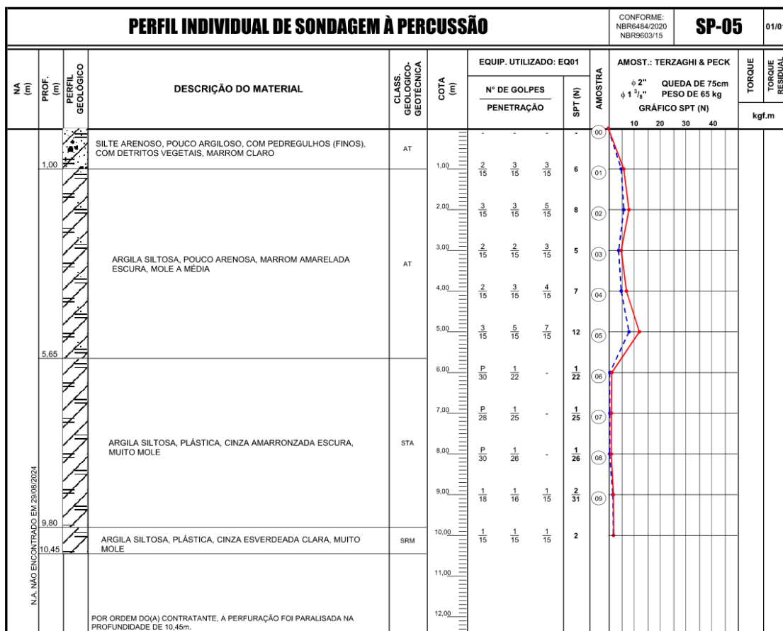
Figura 11- Perfil individual de sondagem à percussão (SP-05)
