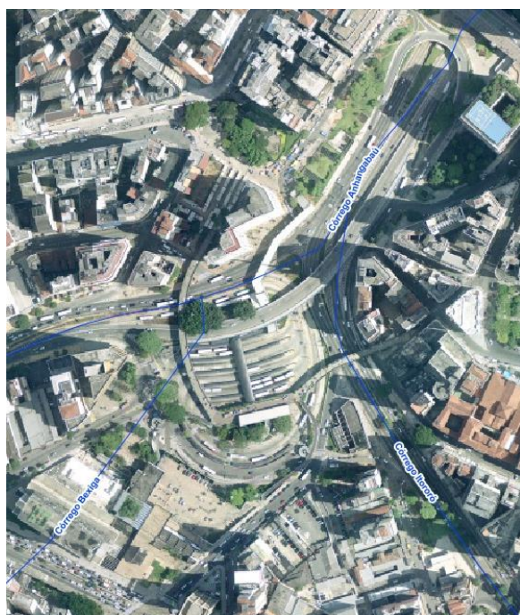
Fig. 5 – Curso dos córregos Itororó e Bexiga desaguando no Córrego Anhangabaú, todos tamponados. Fonte: GeoSampa
