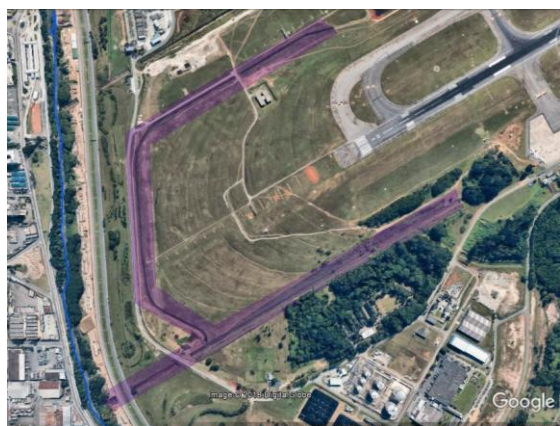
Fig. 9 – Canais de desvio de fluxos (destacados em roxo) no aeroporto de Cumbica, Guarulhos/SP. Na cartografia topográfica Emplasa, tais canais são descritos como valas. Fonte: Google Earth.
