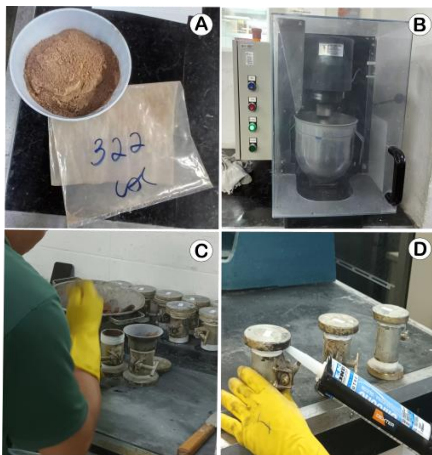
Figura 9 – Etapas do ensaio para a determinação da atividade pozolânica com cal aos sete dias (ABNT 2015a). A – Amostra + \text{Ca(OH)}_2 após homogeneização. B – Mistura mecânico utilizado para formar a argamassa pozolânica. C – Processo de moldagem dos corpos de prova. D – Vedação dos corpos de prova após moldagem, para evitar a perda de umidade.
