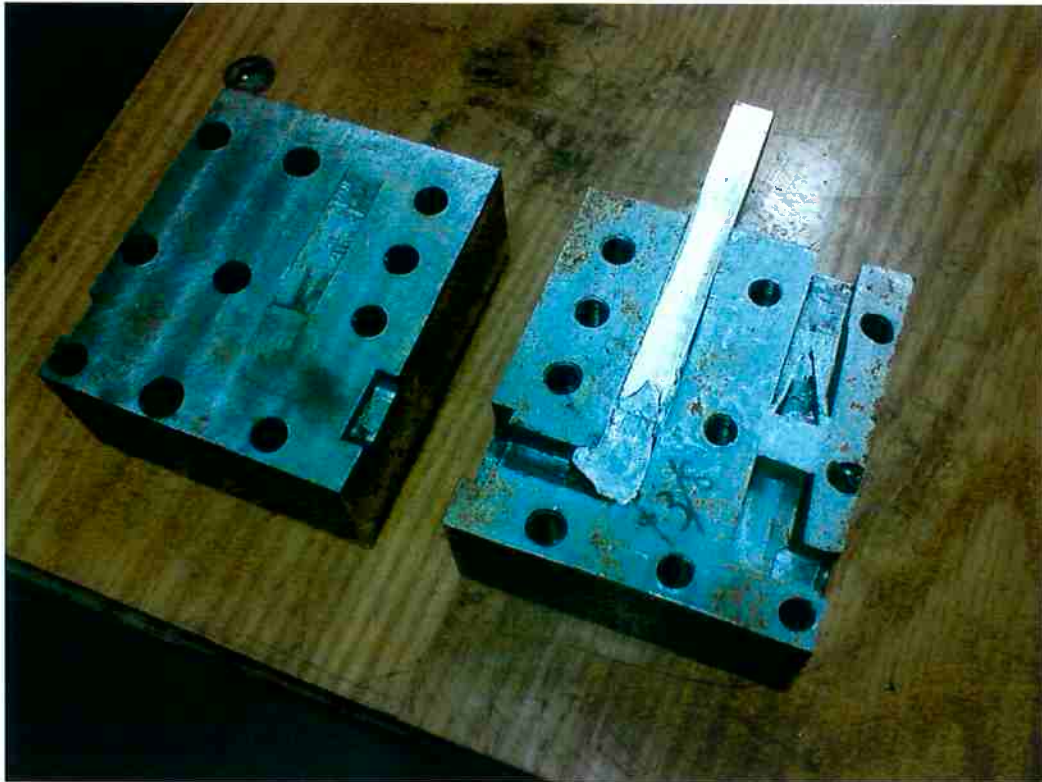
Figura 8 - Segunda Matriz após rompimento
