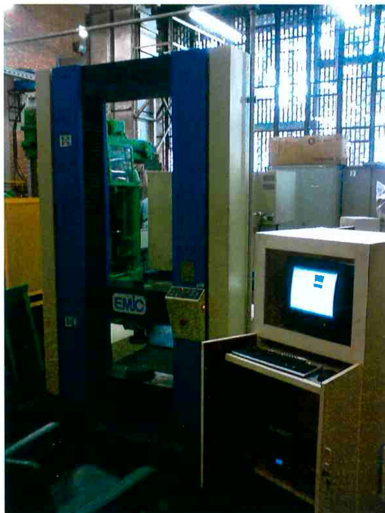
Figura 6 – Máquina de ensaios EMIC – DL 30000 com carregamento máximo de 300KN
