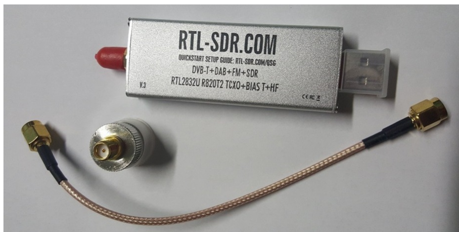
Figura 11 – Dispositivo RTL-SDR utilizado
