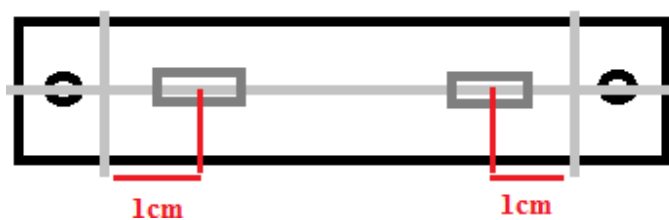
Figura 22 - Posicionamento dos extensômetros no corpo da célula de carga.
