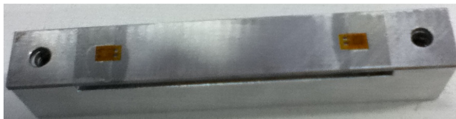
Figura 23 - Extensômetros colados no corpo da célula de carga.
