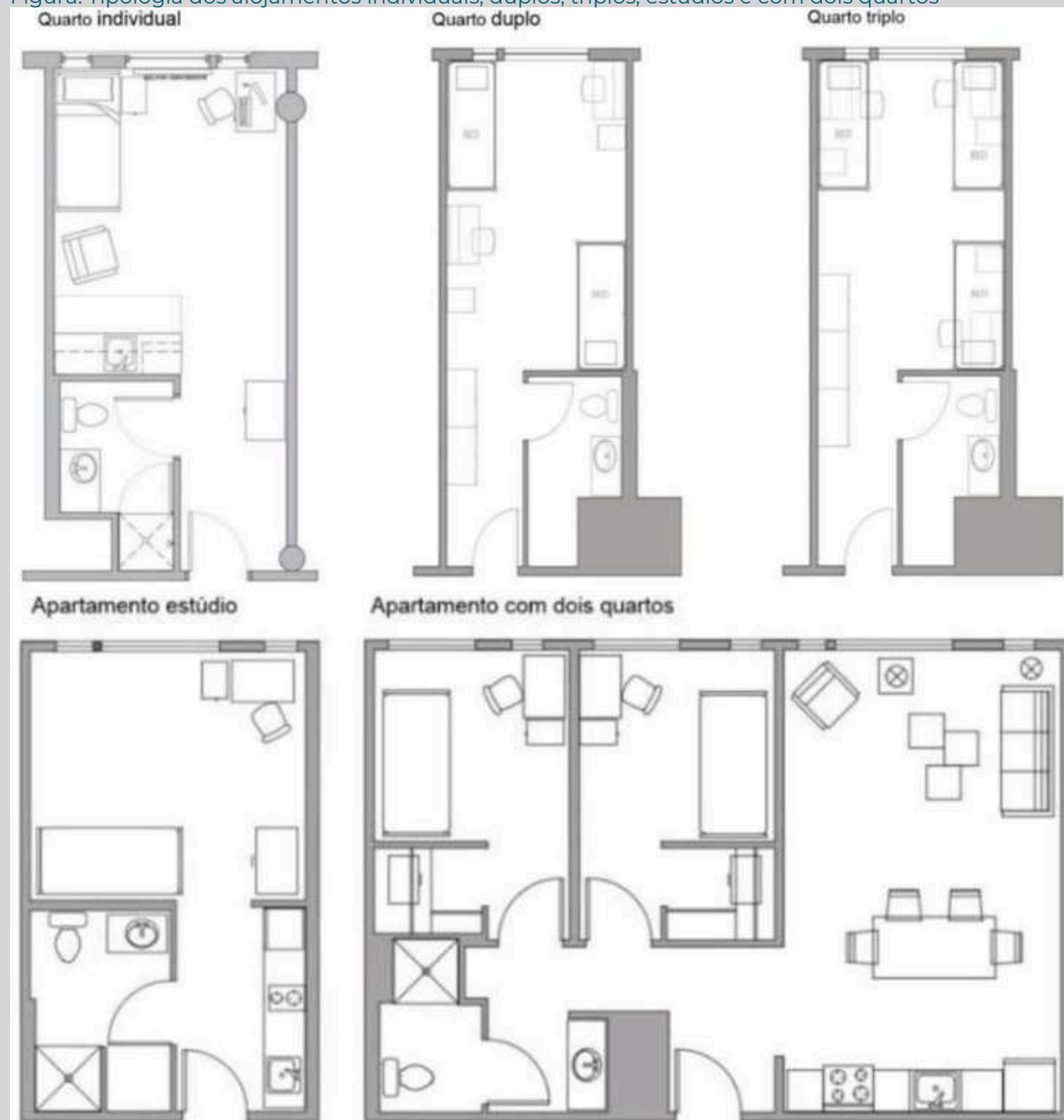
Figura: Tipologia dos alojamentos individuais, duplos, triplos, estúdios e com dois quartos
