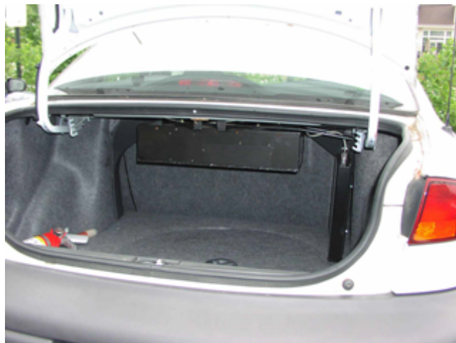
Figura 5 – Centro de coleta de Dados Instalado no porta Malas do Carro (DINGUS et al., 2006)
