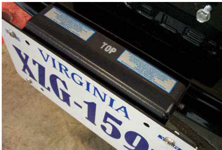
Figura 6 – Antena do Radar Doppler Instalado na parte Traseira do Carro (DINGUS et al., 2006)
