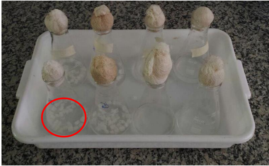
Figura 13 – Preenchimento dos erlenmeyers com espumas de poliuretano para a etapa C, com destaque em vermelho.
