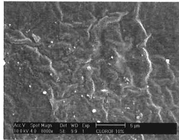
FIGURA 32: AMOSTRA 10% COPOLÍMERO + 90% CLOROFÓRMIO (A) AUMENTO 5000X (B) AUMENTO 8000X.
