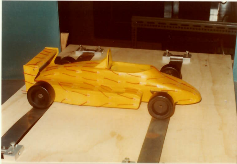
Foto 3: Experiência para verificação de turbulências. Notar como os fios na parte lateral inferior são "sugados" por baixo do carro, devido à baixa pressão ali existente.
