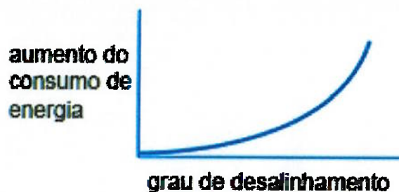
Gráfico 1 - Relação entre desalinhamento e aumento do consumo de energia (fonte: SKF, 2011)
