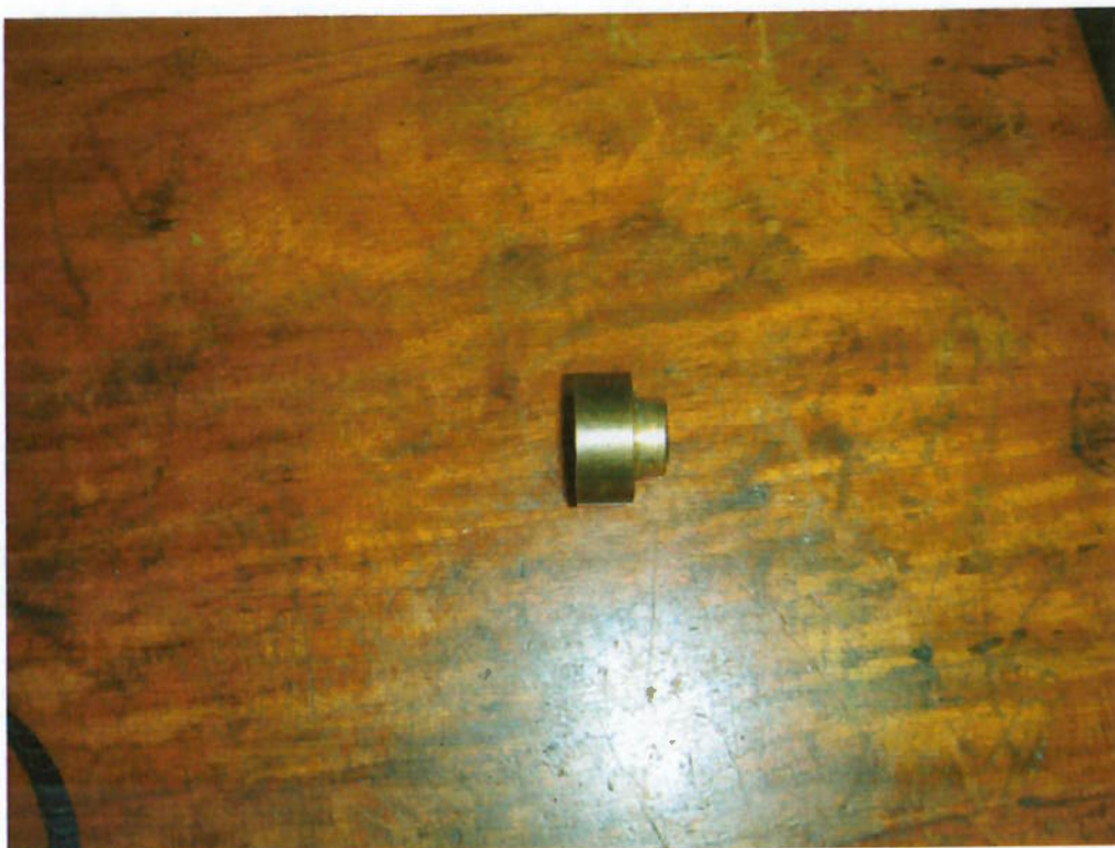
Figura 4 - Bujão calibrado com furo de 0,5 mm para montagem nas cadeiras de alinhamento (vista lateral)
