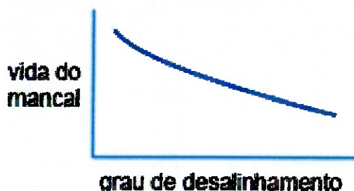
Gráfico 2 - Relação entre desalinhamento e vida do mancal (fonte: SKF, 2011)
