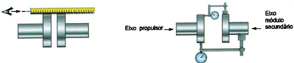
Figura 18 - Esquema de aproximação e do posicionamento dos relógios comparadores para alinhamento (fonte: SKF, 2011, modificado)
