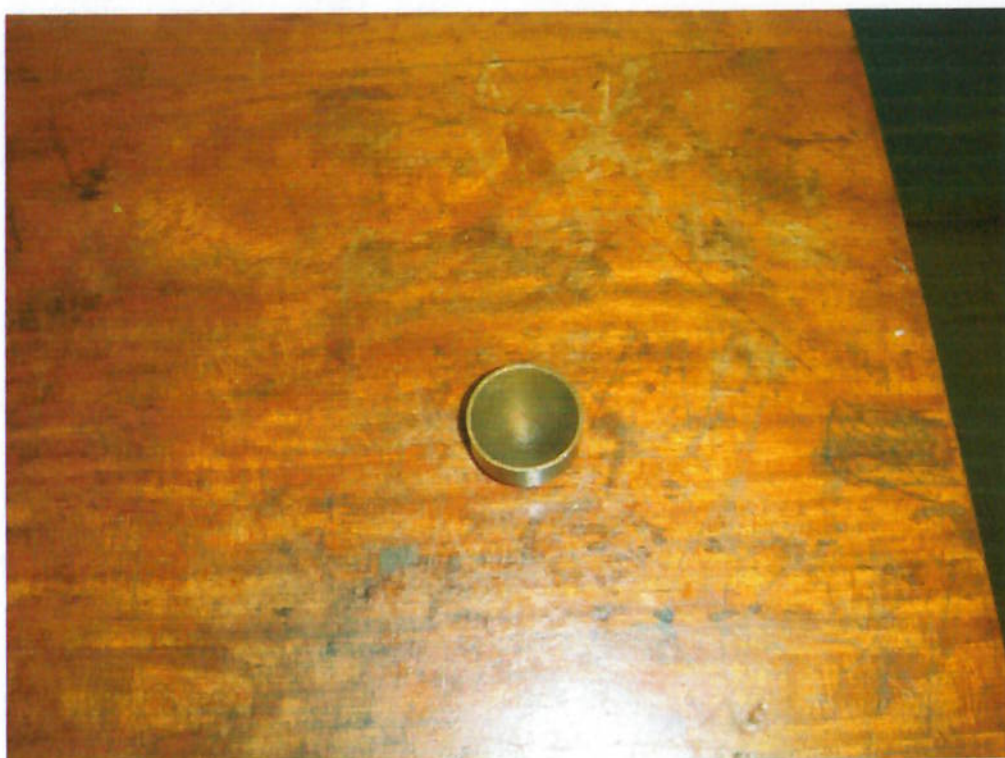
Figura 3 - Bujão calibrado com furo de 0,50 mm para montagem nas cadeiras de alinhamento
