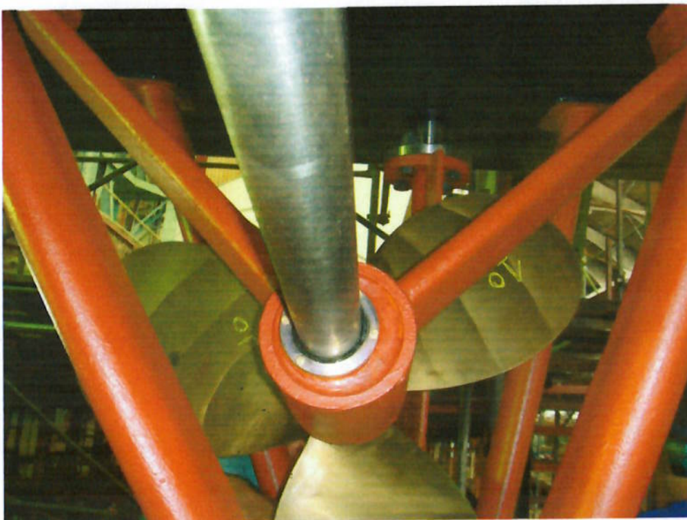
Figura 22 - Bucha montada excêntrica para correção do alinhamento
