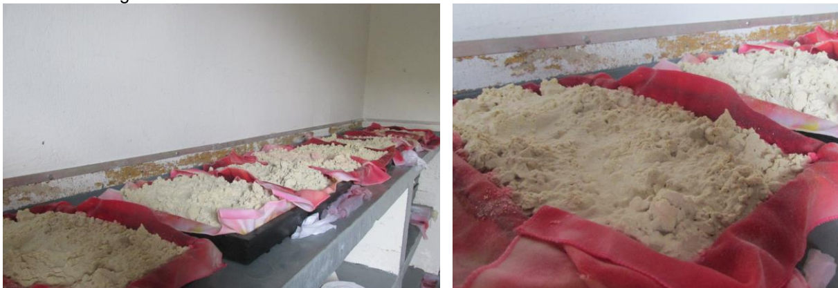
Figura 13 - Armazenamento da azida de chumbo embebida em óleo de rícino
