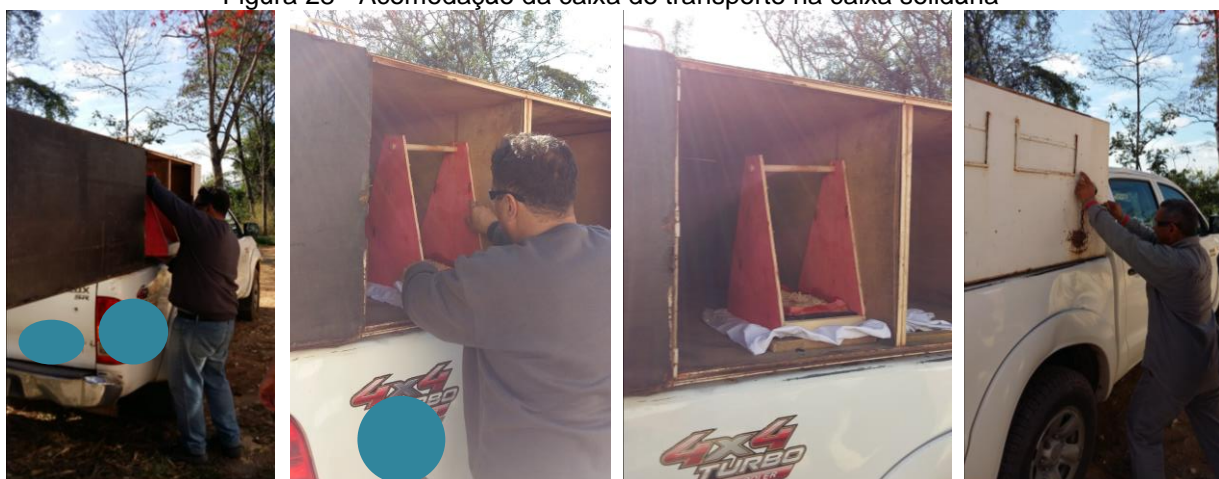
Figura 28 - Acomodação da caixa de transporte na caixa solidária
