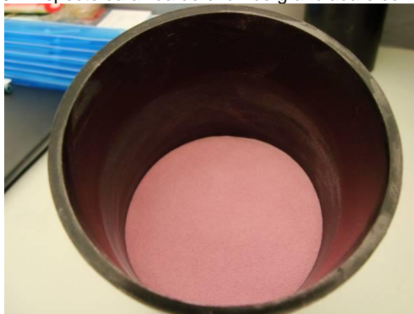
Figura 9 – Aspecto da azida de chumbo granulada e com corante
