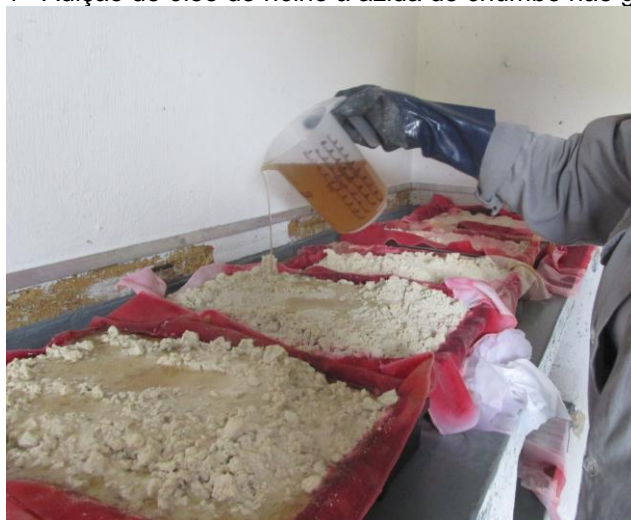
Figura 14 - Adição de óleo de rícino à azida de chumbo não granulada
