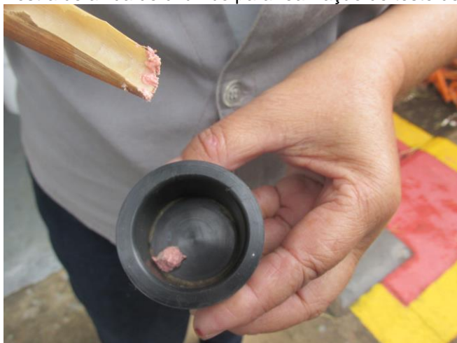
Figura 16 - Amostra de azida de chumbo para realização de teste de sensibilidade
