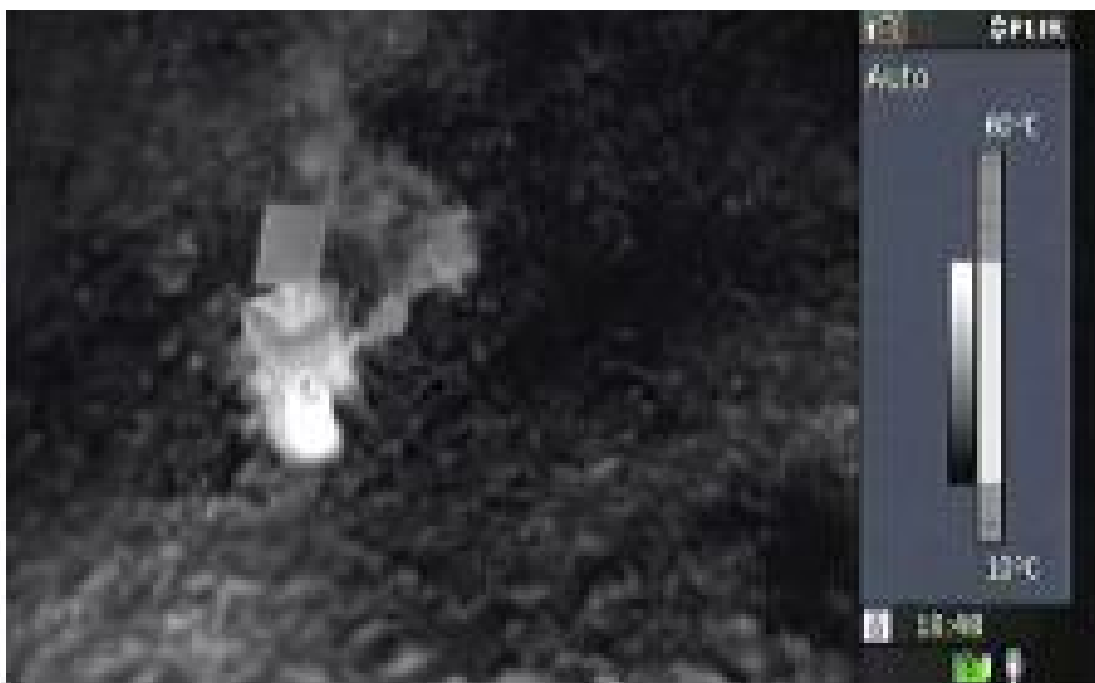
Figura 17 – Imagem de vazamento gás captada por câmera com infravermelho
