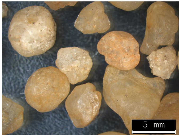
Figura 11. Grãos de quartzo em diferentes granulometrias vistos em lupa binocular no laboratório de petrografia sedimentar (LABPetro).
