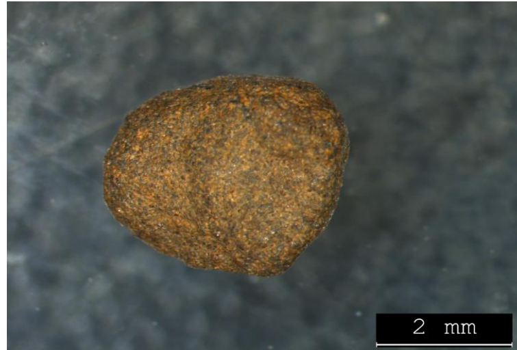
Figura 26. Grão mineral referente à amostra TF17 composta por hematita e ilmenita.
