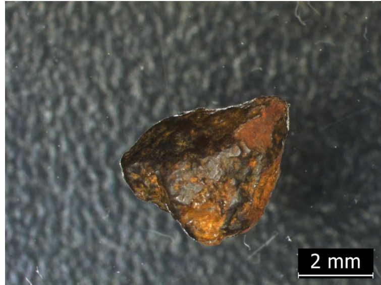
Figura 22: Grão mineral referente à amostra TF21 constituída por magnetita.
