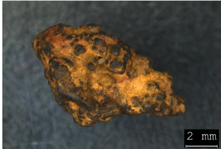
Figura 20. Grão mineral referente à amostra TF10, cujos principais minerais pesados são montmorillonita e goethita.
