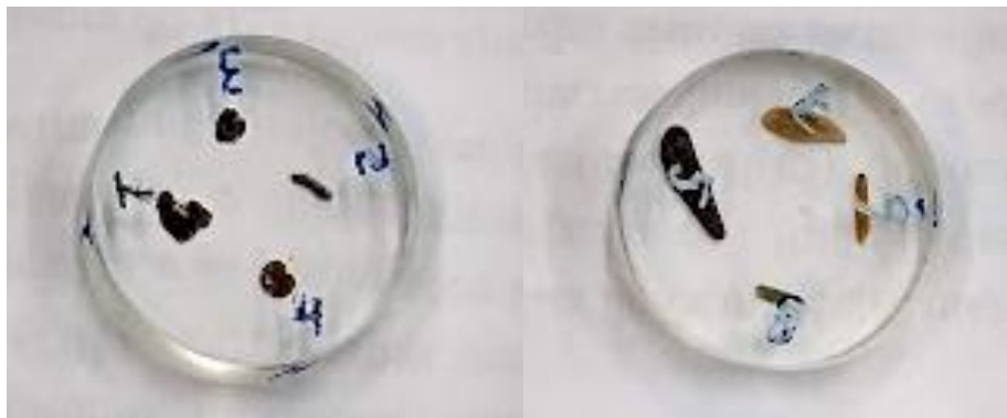
Figura 8. Amostras de grãos minerais preparadas em seção de laminação com dimensões de 25x25x7mm para cada lâmina circular. Para a primeira seção temos em (1) TF20, (2) TF9, (3) TF5a e (4) TF18. Para a segunda seção temos em (5) TF6, (6) TF19, (7) TF4 e (8) TF15.
