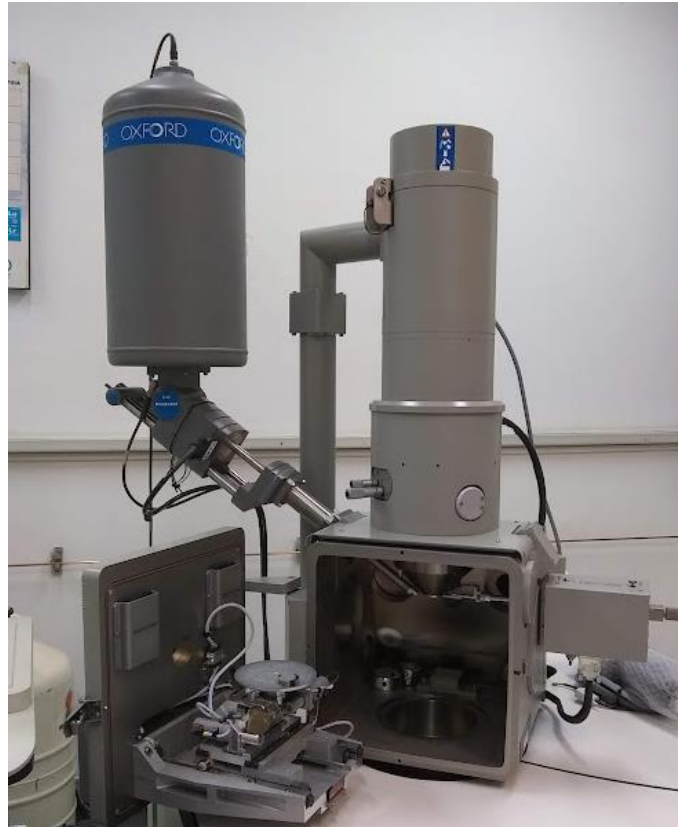
Figura 9. Microscópio eletrônico de varredura do laboratório MEV, do IGc - USP. O equipamento pode ser dividido em três partes principais: canhão de feixe de elétrons, na parte superior; tubo com filamento de tungstênio, na parte intermediária; e câmara de incidência e reflexão de elétrons, na parte inferior, onde coloca-se a seção para análise.
