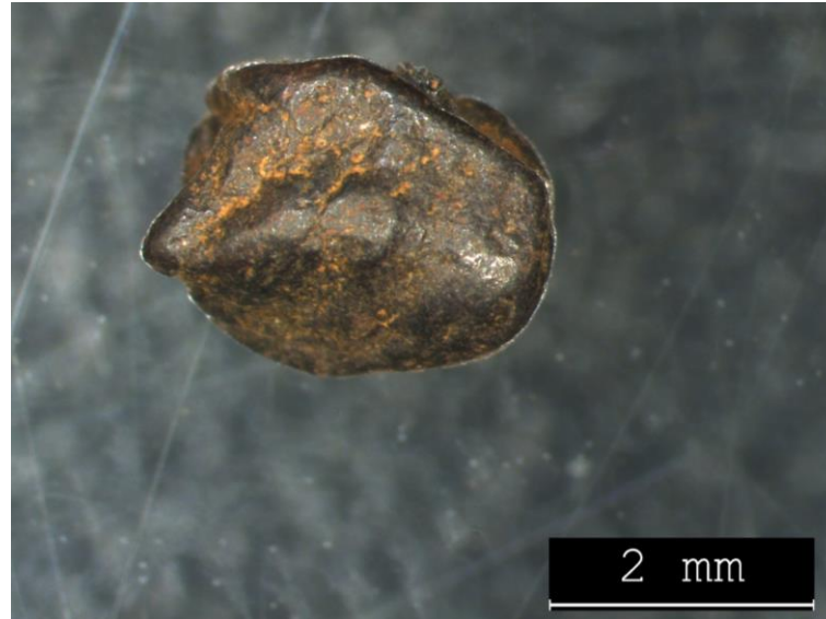
Figura 24. Grão mineral referente à amostra TF5a composta por hematita.
