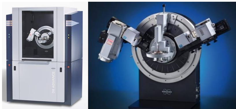
Figura 7. Difratômetro D8 Advance Da Vinci utilizado no laboratório de difração de raio X (LDRX).
