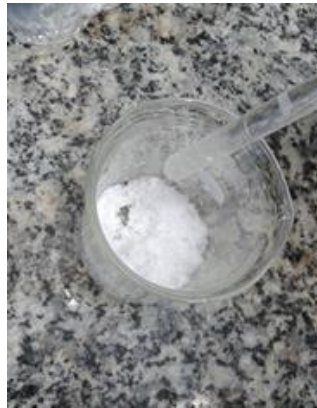
Figura 7 - Catálise ácida – Mistura de ácido aspártico e ácido fosfórico.
