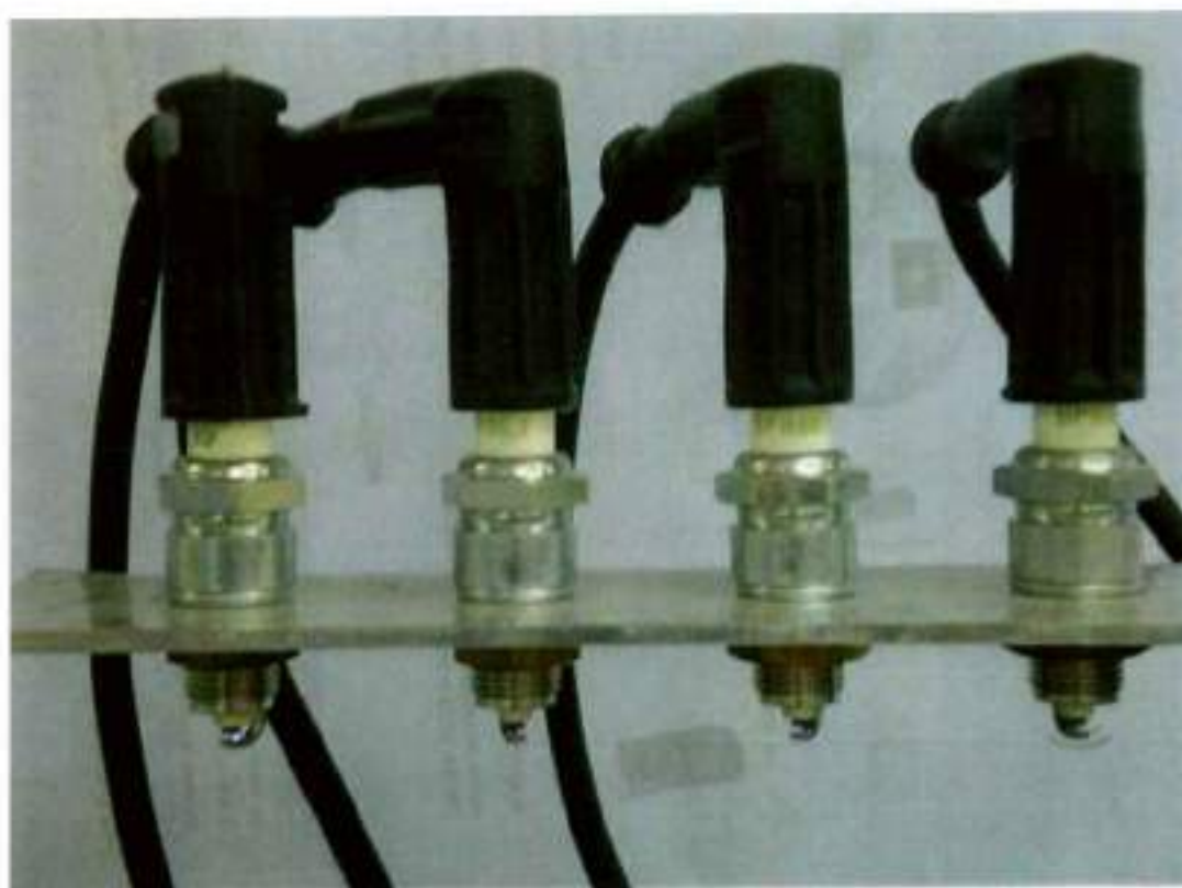
Figura 11. Visão em detalhe das velas durante o acionamento.
