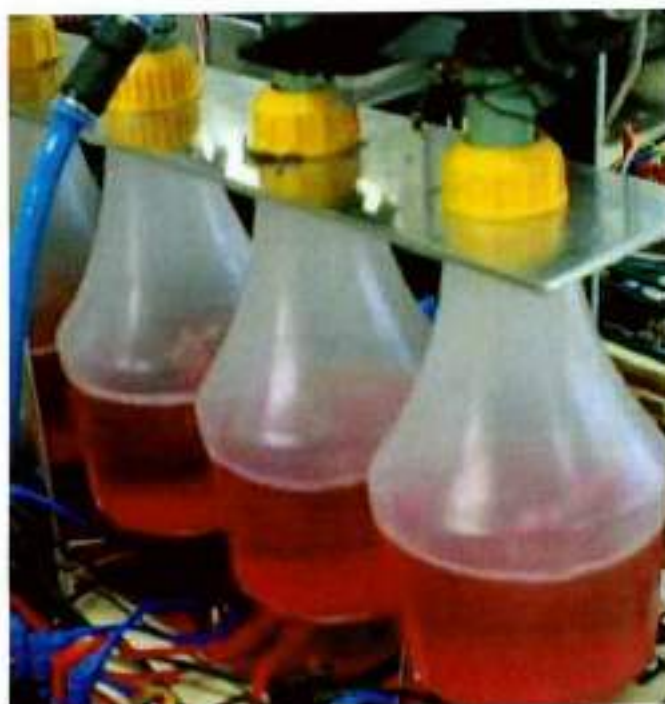
Figura 15. Visão em detalhe dos bicos injetores durante o acionamento.
