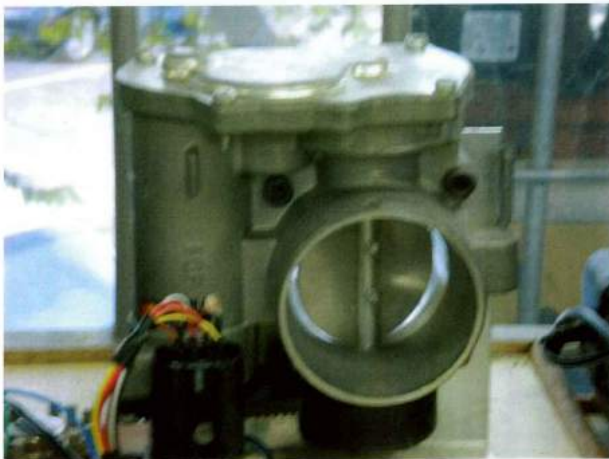
Figura 20. Válvula aberta no ângulo equivalente ao arranque.
