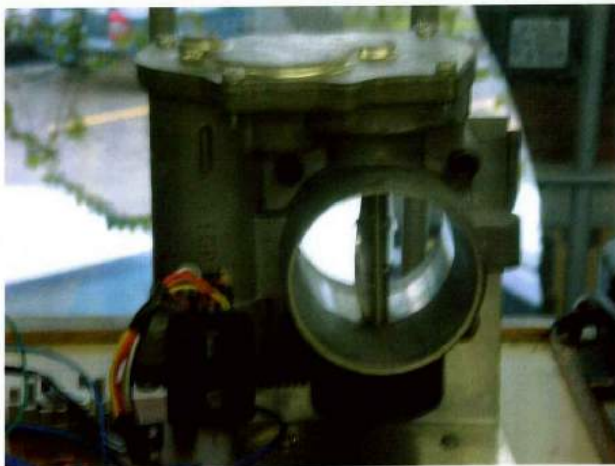
Figura 21. Válvula totalmente aberta.
