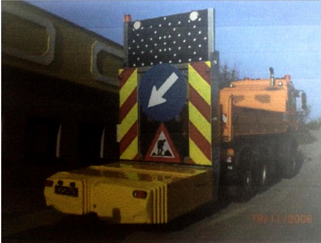
Figura 3 – Caminhão com Amortecedor Traseiro (CAT). Fonte: ECOVIAS, Manual Sinalização de Obras (2013).
