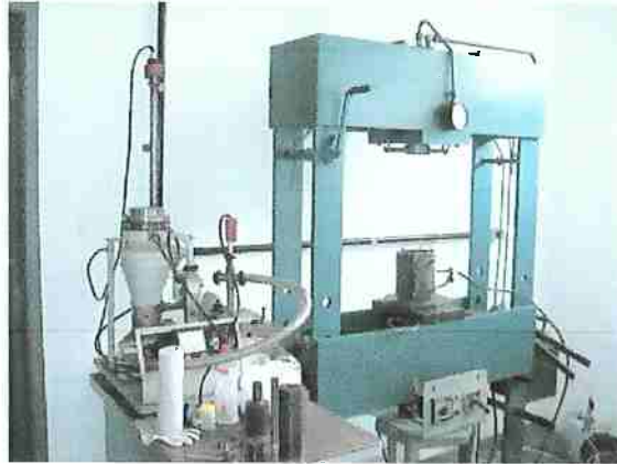
Figura 09 – Equipamento de compactação e extrusão
