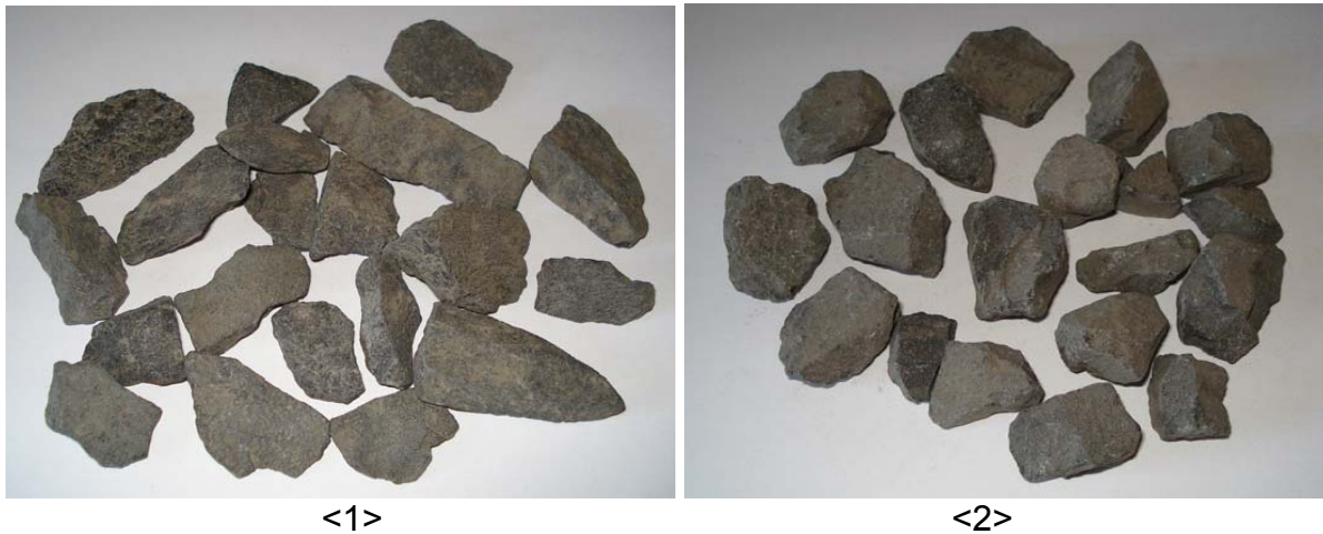
Figura 3.3.4 – Formato dos agregados graúdos utilizados no concreto em ensaios realizados no laboratório.
