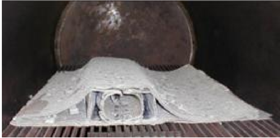
Figura 30: Peça de uma pá de aerogerador após o processo de pirólise.
