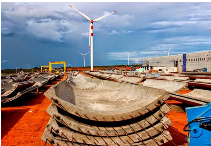
Figura 12: Peças da torre pré-moldada de concreto.
