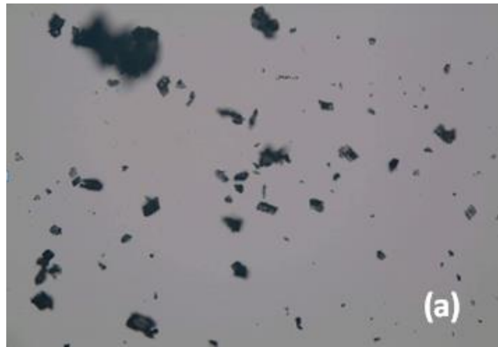
Figura 6 – Acompanhamento da fusão do escitalopram por microscopia com hot stage nas temperaturas (a) 139, (b) 148 e (c) 156°C.
