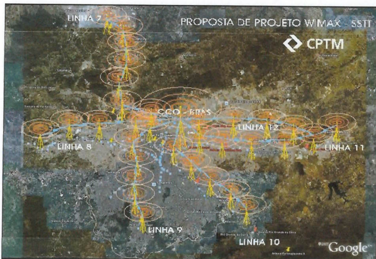
Figura 12 – Topologia do backhaul do sistema de transmissão WiMAX móvel proposto para o sistema SSTS da CPTM.
