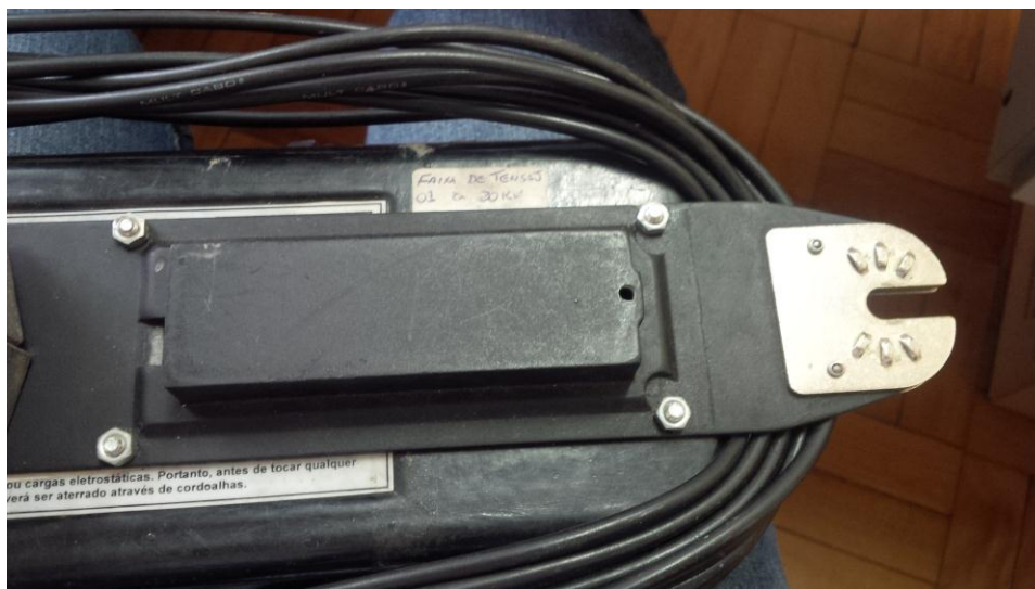
Figura - Adaptador do dissipador para conexão com vara de manobra.
