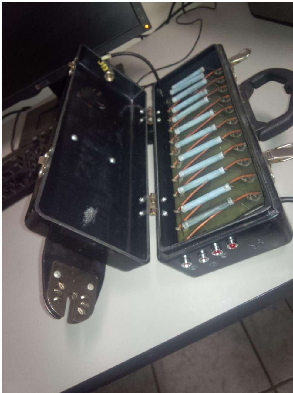
Figura - Protótipo Dissipador de Tensão.
