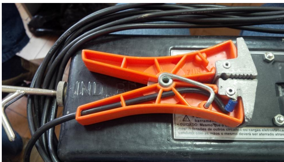
Figura - Garra de aterramento do dissipador.
