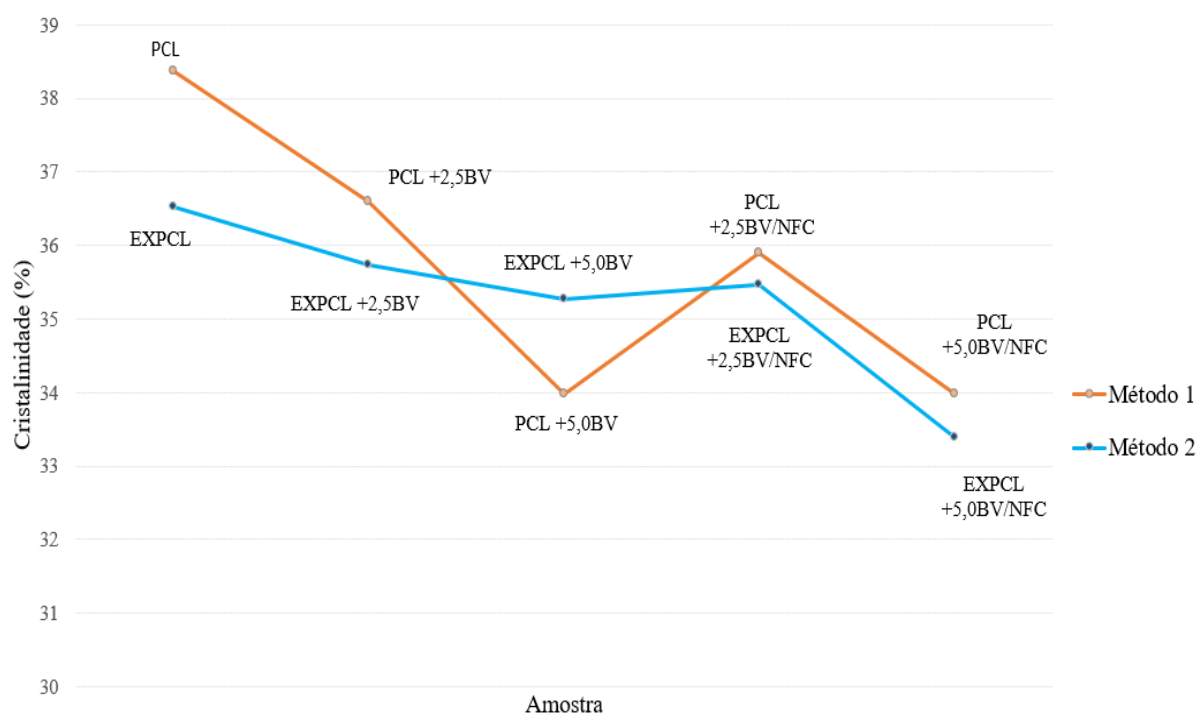
Figura 23: Gráfico comparativo da cristalinidade das amostras processadas pelos métodos 1 e 2
