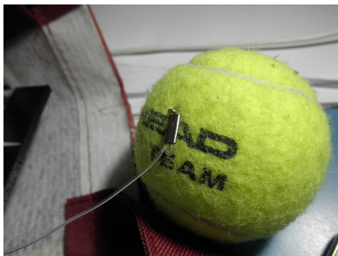
Figura 62 – Detalhe da fixação do fio de nylon à bola de tenis
