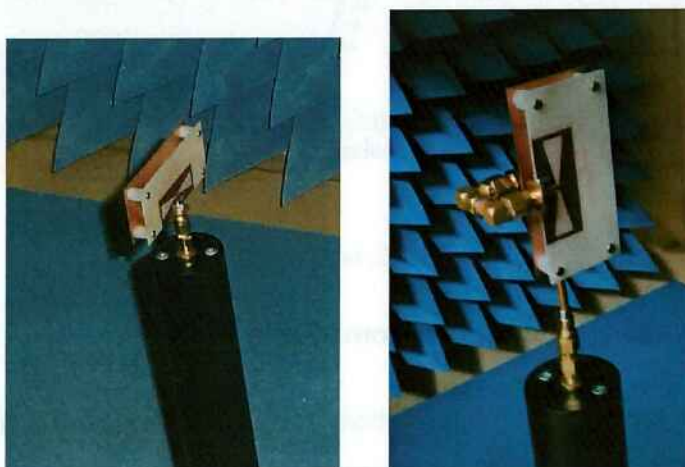
Figura 36 - Antena para medição em x-y e com ajuste para correta medição de z-x.
