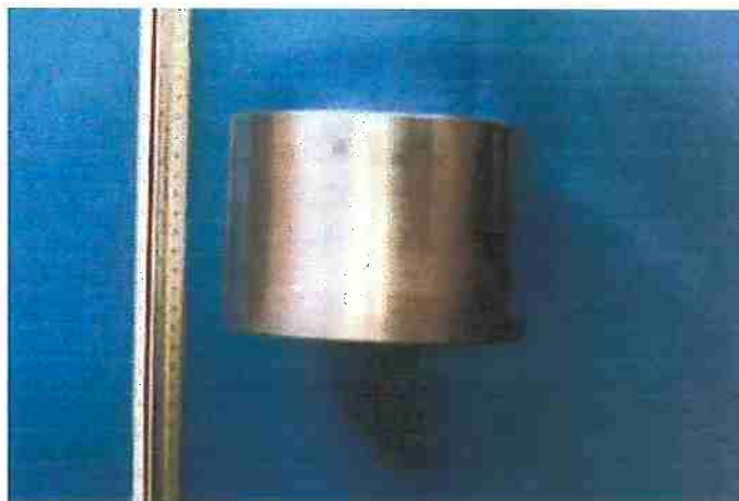
Figura 7-1 — Pré-formado como recebido (liga AA 7075).
