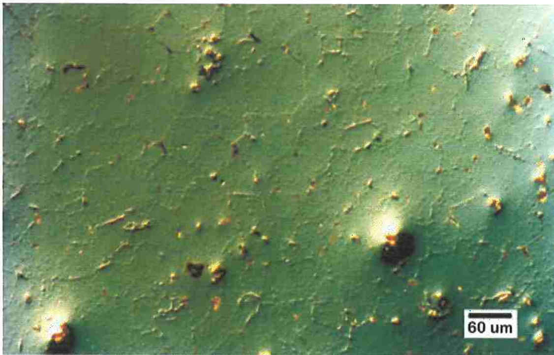
Figura 8-9 — Microestrutura da liga AA 7075 (DIC).
