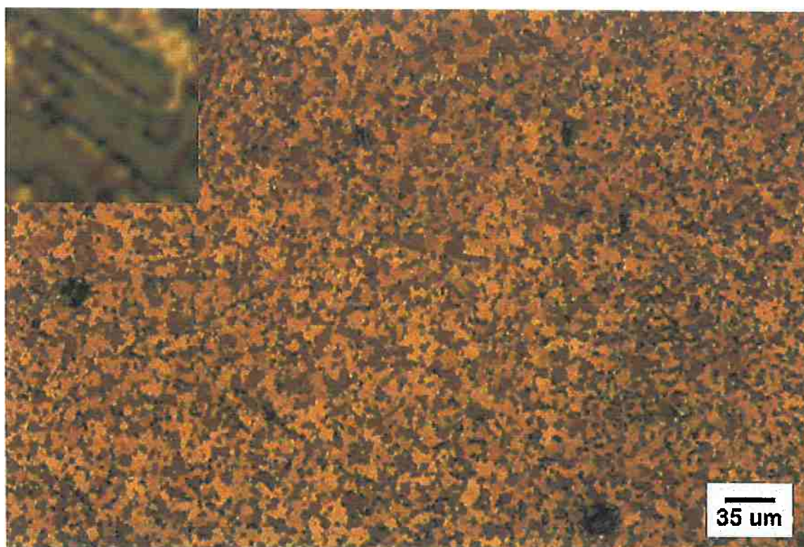
Figura 8-8-1 — Comparação microestrutural (IM x OM) da liga Al-Si-Cu.
