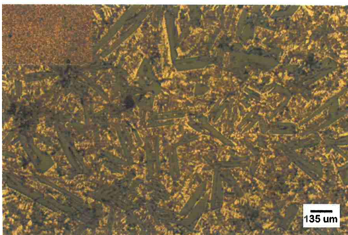
Figura 8-8-2 — Comparação microestrutural (IM x OM) da liga Al-Si-Cu.
