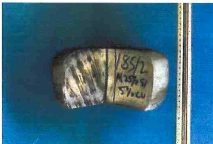
Figura 7-2 — Pré-formado como recebido (liga Al-Si-Cu).
