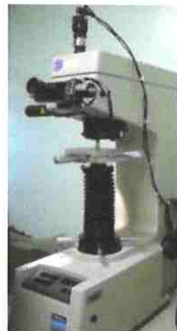
Figura 7. Ensaio de dureza Vickers.
