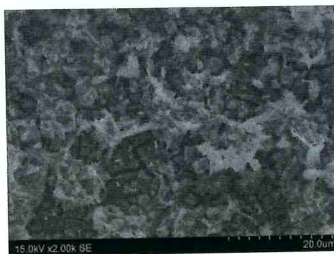
Figura 25. Micrografia por microscopia eletrônica de varredura do vidro sem iodo depois do estudo de durabilidade com uma solução de pH 7.
