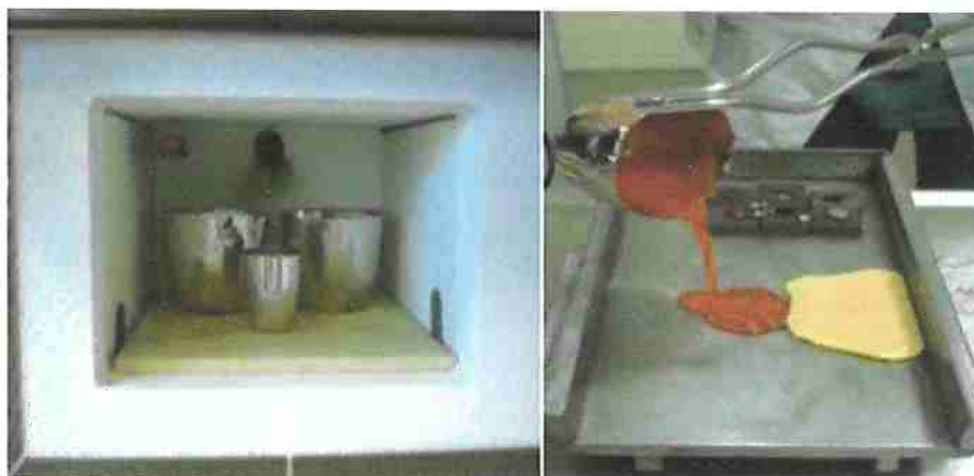
Figura 6. Preparação dos vidros nos cadinhos de platina a 650°C (esquerda), e vazamento dos vidros (direita).
