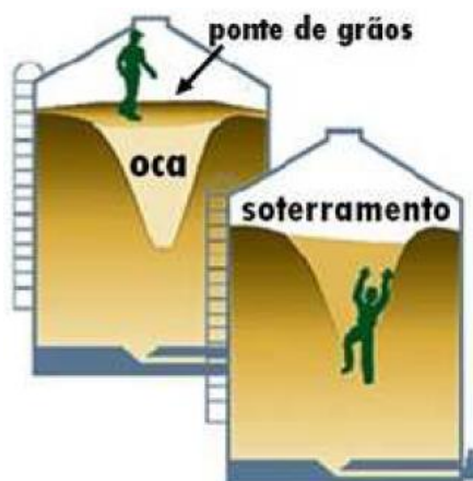
Figura 10: Colapso de ponte de grãos. Fonte: (ACCA, 2001).
