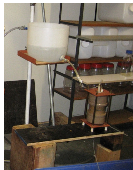
Figura 24 - Esquema de sistema hidráulico de carga constante com reservatório de volume constante, modificado de Daniel (1994) e sistema utilizado
