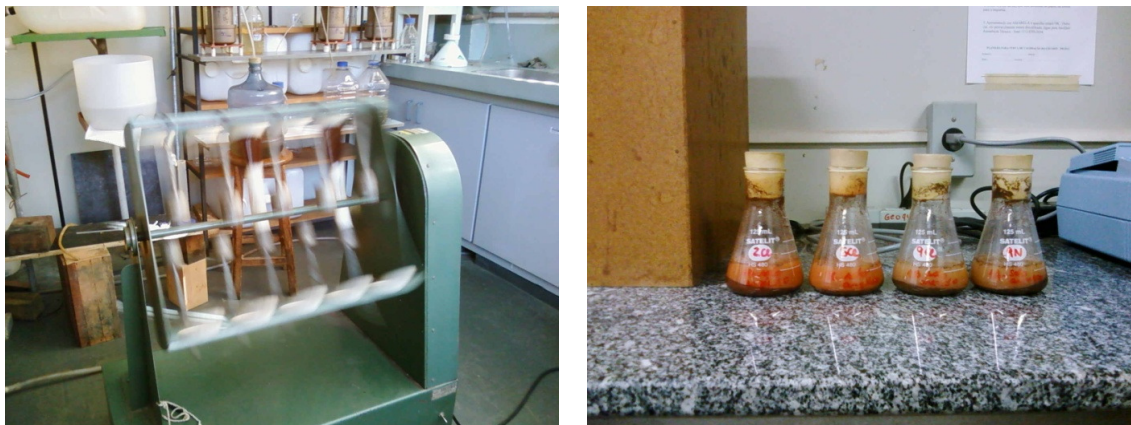
Figura 18 - Condutividade elétrica, pH e Eh – agitador mecânico e erlenmeyers contendo as suspensões
