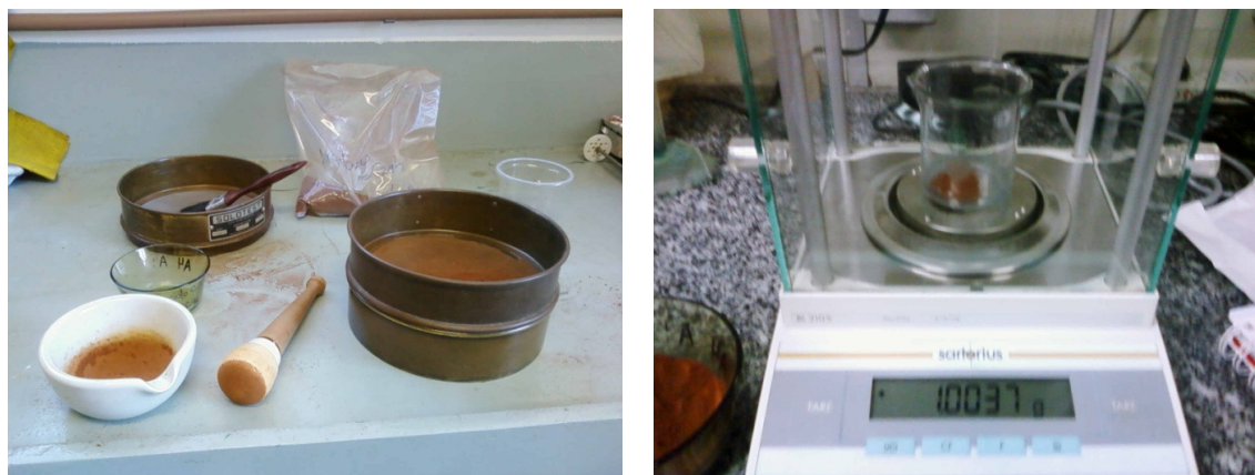
Figura 19 - CTC e SE – peneiramento da amostra em peneira #100 e determinação da massa de solo
