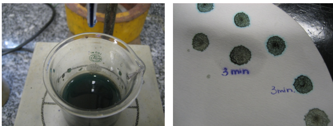
Figura 20 - CTC e SE - Titulação com azul de metileno e papel filtro contendo gotas da suspensão titulada
