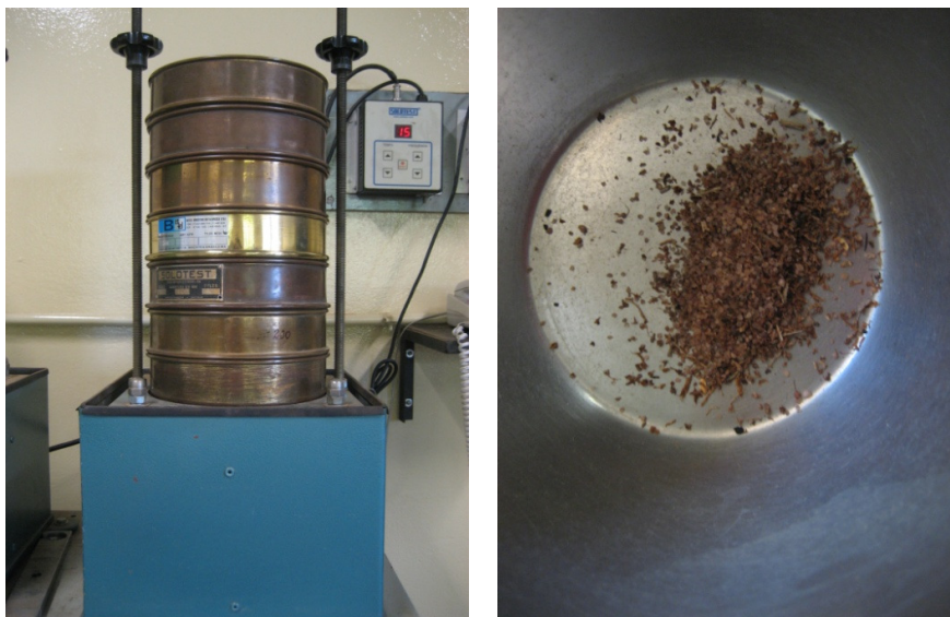
Figura 14 - Granulometria conjunta – amostra sendo peneirada e material retido em uma das peneiras
