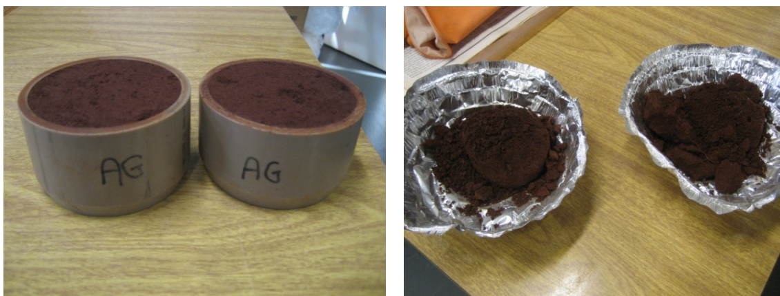
Figura 6 - Massa específica seca – amostras indeformadas em anéis de PVC e em bandejas de alumínio após secagem em estufa
