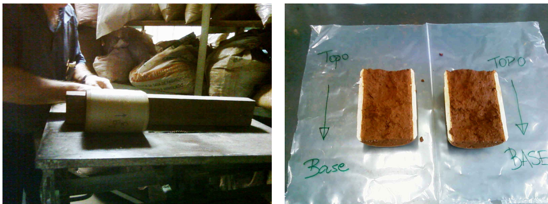
Figura 31 - Abertura de coluna após ensaio de percolação
