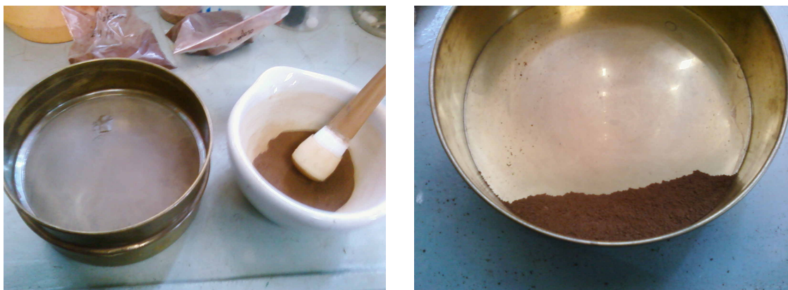
Figura 15 - ATD – Maceramento, peneira #200 e material peneirado
