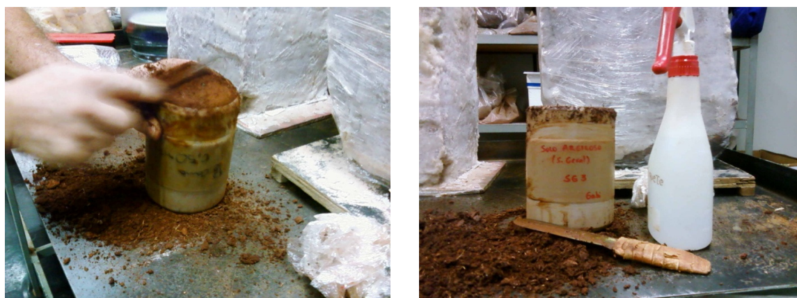
Figura 22 - Rasamento das colunas do solo tipo C
