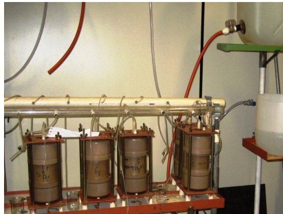
Figura 27 - Aplicação ascendente de água deionizada para saturação e lavagem das colunas
