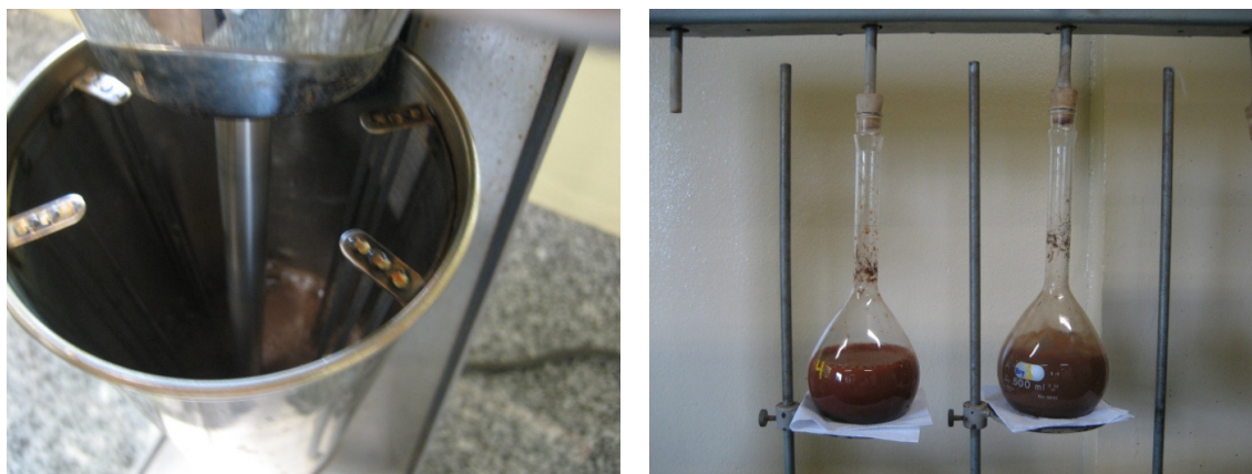
Figura 8 - Massa específica dos sólidos - Dispersão em agitador mecânico e deairação em bomba de vácuo
