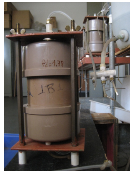
Figura 23 - Esquema de permeâmetro de parede fina, adaptado de Daniel (1994), e permeâmetro utilizado
