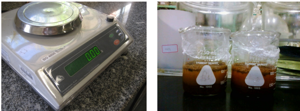
Figura 7 - Massa específica dos sólidos - Balança utilizada e amostras de solo em contato com água destilada
