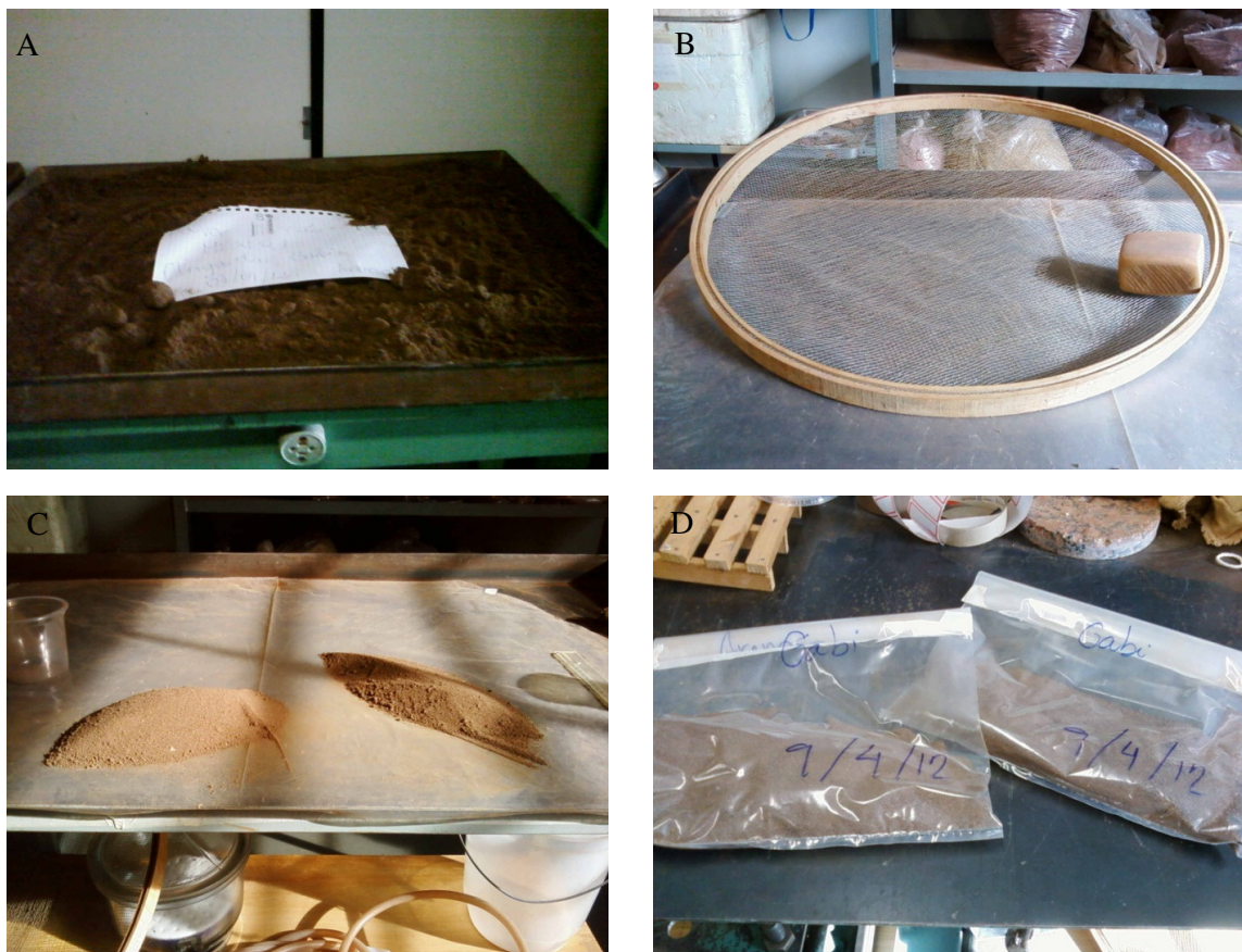
Figura 5 - A – solo em bandeja para secagem ao ar; B – peneira e destorroador de madeira utilizados no preparo das amostras; C – quartejamento; D – armazenamento das amostras preparadas
