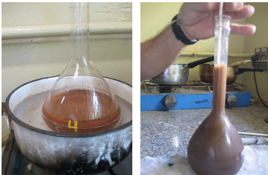
Figura 9 - Massa específica dos sólidos – Aquecimento do picnômetro e homogeneização da suspensão
