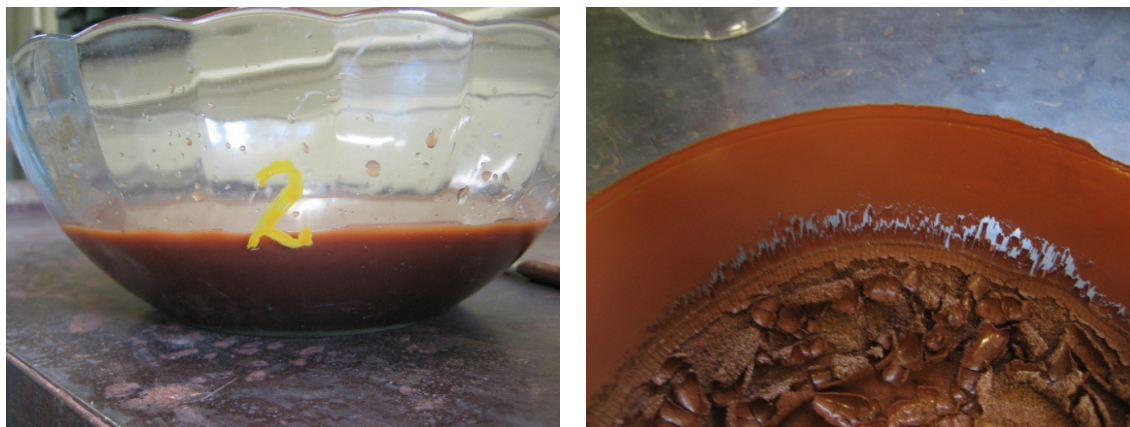
Figura 10 - Massa específica dos sólidos - Amostra antes e após secagem em estufa
