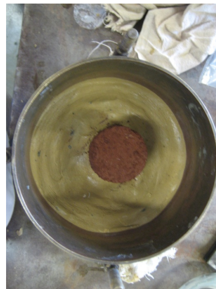
Figura 25 - Esquema de permeâmetro com corpo de prova e selante, modificado de Daniel (1994), e corpo de prova no interior do permeâmetro
