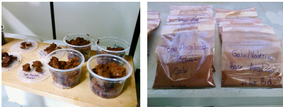
Figura 32: Secagem e armazenamento das amostras de solo após ensaio de percolação
