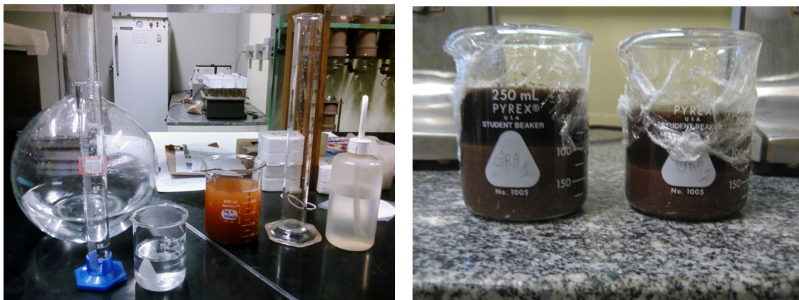
Figura 11 - Granulometria conjunta – Adição de solução de defloculante e amostras em descanso
