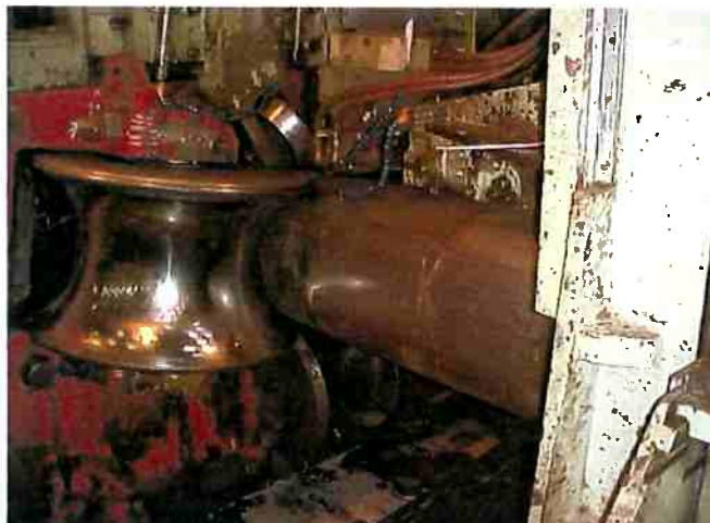
Figura 11 – Etapa de soldagem dos tubos [16].
