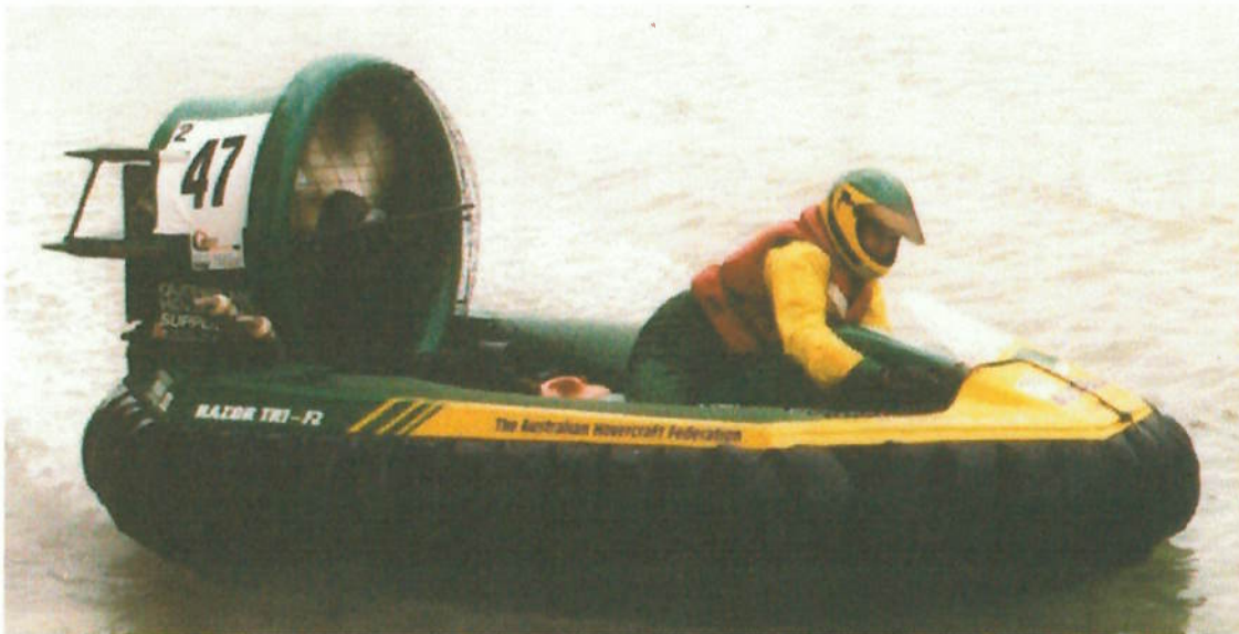
Hovercraft da saia segmentado com somente uma hélice.
