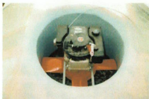
Motor de sustentação montado diretamente sobre a hélice.
