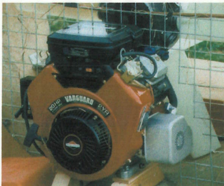
Motor de propulsão (20HP) montado em um hovercraft
