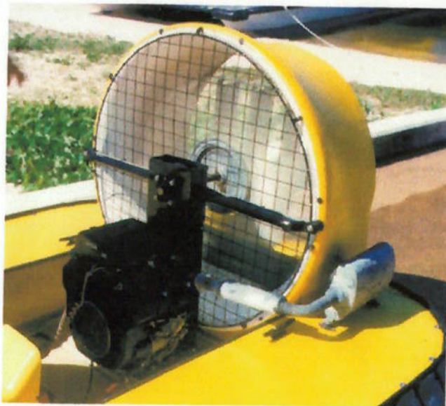
Hélice de propulsão carenada por um duto cilíndrico
