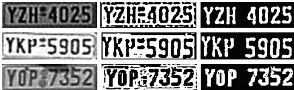
Figura 2.11 - Segmentação bem-sucedida dos caracteres da placa veicular. Extraída de (ANAGNOSTOPOULOS et al, 2006)
