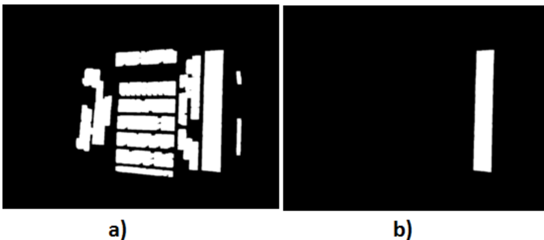
Figura 2.5 - a) Imagem dilatada para facilitar a localização do código de barras. b) Extração do código de barras.
