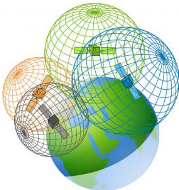
Figura 12: Princípio de multilateração para um espaço tridimensional
