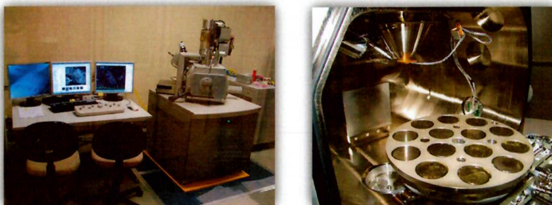
Figura 3 - MEV utilizado nos estudos de caracterização e detalhe do porta-amstras para MLA
