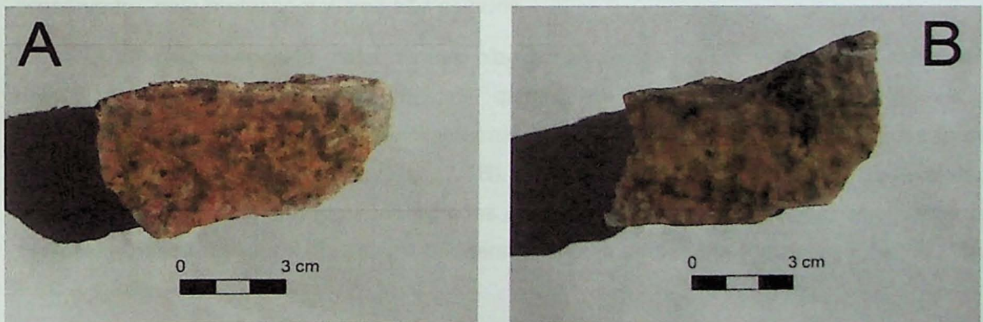
Figura 3 – Unidade Granito I – Suíte Intrusiva Parauari: (A) monzogranito do ponto NP-245 e (B) NP-247, com cor rosa-avermelhado em decorrência do metassomatismo potássico.
