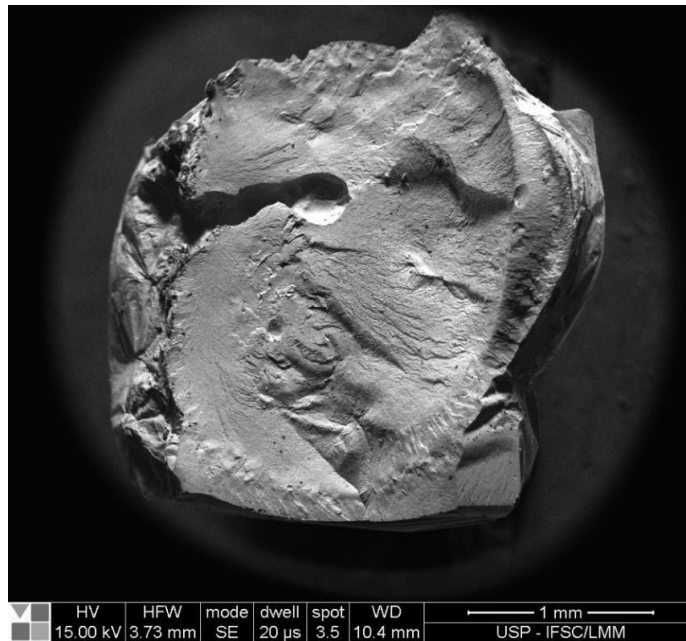
Figura 18: MEV da amostra I-120 mostrando a região de fratura com total união metalúrgica.
