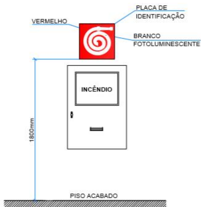
DETALHE DE SINALIZAÇÃO DOS HIDRANTES SEM ESCALA
