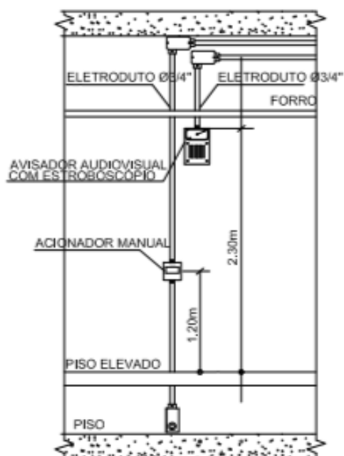
DETALHE 07 - ACIONADOR MANUAL SEM ESCALA
