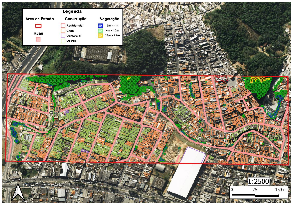
Figura 6.3.4.1 – Teste de segmentação para vegetação, ruas e construções usando o complemento MapFlow .
