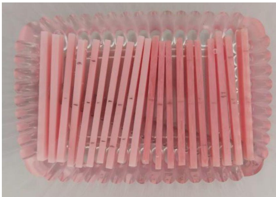
Fig.2 – espécimes de resina termopolimerizável para o ensaio de resistência à flexão. Os espécimes rosas claro, à esquerda, são de resina para impressão 3D e, os rosas escuros, à direita, são de resina termopolimerizada.
