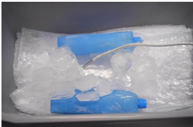
Figura 24 - Instalação do Sensor de Temperatura Antes da Colocação das Vacinas
