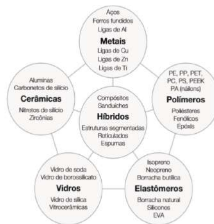
Figura 2: Divisões dos tipos de materiais de engenharia.
