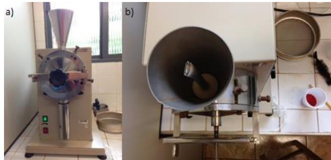
Figura 17 – Moinho laboratorial: a) vista frontal e b) vista superior.
