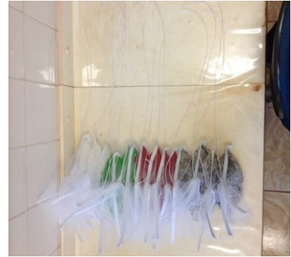
Figura 24 – Estruturas preenchidas com os pellets e com as cordas para exposição nos mesocosmos.
