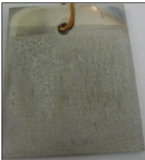
Figura 18: Aspecto do corpo-de-prova após as duas últimas demãos para proporção molar MMA/TEOS/MPTS igual a 2/4/1
