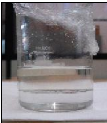
Figura 17: Aspecto do sol-gel com proporção molar MMA/TEOS/MPTS igual a 2/4/1 após 30 minutos de sua obtenção
