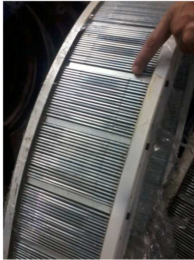
Figura 33 – Pente restaurado com estrutura mais resistente
