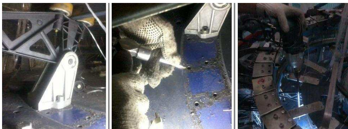
Figura 38 – Procedimentos para tirar um parafuso quebrado
