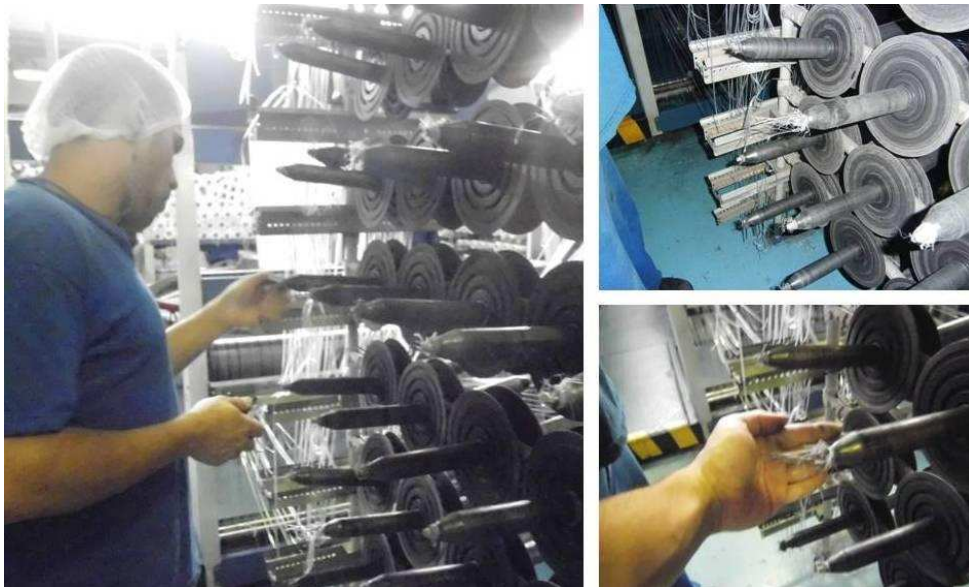
Figura 18 – Limpeza dos discos das gaiolas durante realização da Troca Total
