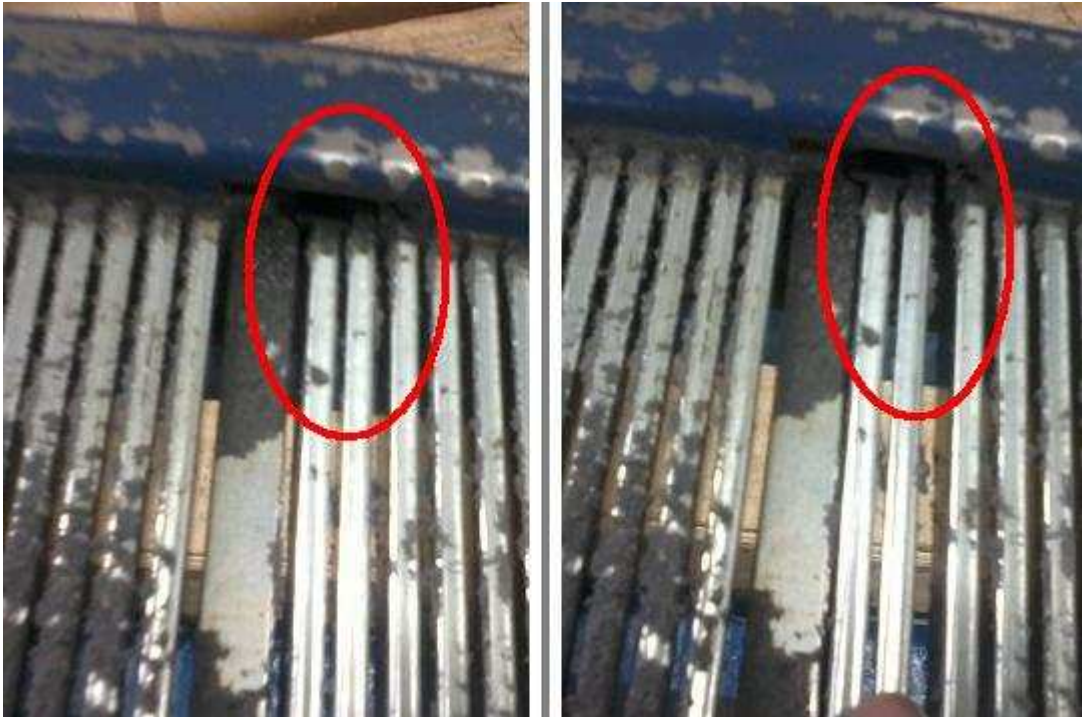
Figura 34 – Puas em posições diferentes devido ao rompimento da cola, causando obstrução da passagem
